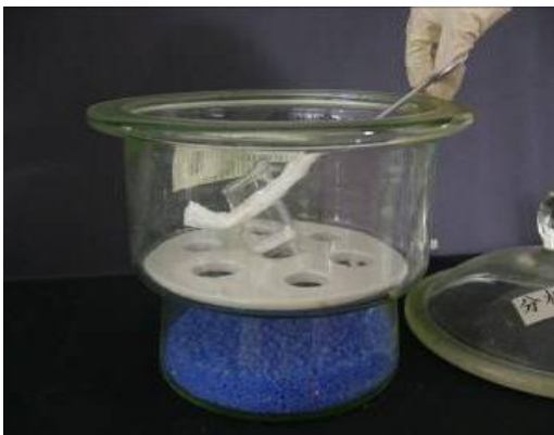
圖 4-3 將燒結玻璃濾器放入乾燥器
