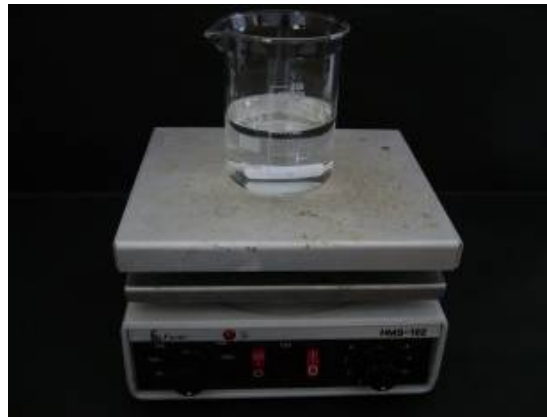
圖 3-1 使用攪拌子加速樣品溶解
